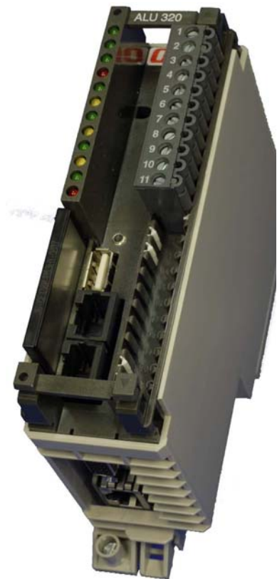
Bild 3-2: Frontansicht der ALU320 mit dem CF Steckplatz, den beiden RS232 Schnittstellen und dem ersten USB-Anschluss. Der RJ45 Ethernet-Steckverbinder befindet sich auf der Geräteunterseite.
