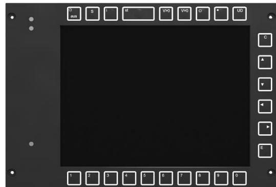
Reengineering eines Multifunktionsdisplay für einen Zugführerstand als Ersatz für ein nicht mehr erhältliches Gerät (MFD10)
